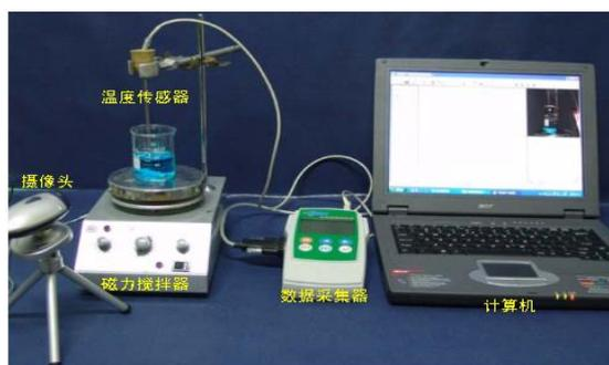
数字化手持技术实验室，又称为掌上实验室（Lab In Hand），是由计算机和微电子技术相结合的新型数字化实验手段，主要包括：数据采集器、传感器、计算机及其配套软件三个部分。数字化实验设备高速度的数据采集功能和可视化的实验结果能够极大地调动学生学习的积极性，提高教学效率，充分体现了现代信息技术与课程教学整合的优势，为我院化学师范专业学生的实验教学和探究能力培养提供了新的实验平台。
